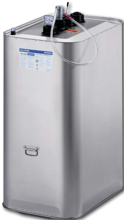
5 Dieseltank Economy 999 L Preiswerter Diesel/Heizöltank in doppelwandiger Ausführung. Füllinhalt max. 999 Liter, verzinkter Außenbehälter mit Tragegriffen und korrosionsfreier Innenbehälter aus Kunststoff. Maße: LxBxH 1135x727x1540 mm, Eigengewicht ca. 80 kg. Lieferung ohne Pumpe jedoch komplett mit Leck- und Füllstandsanzeige. Best. Nr. H 97559 EUR 748,00 Frachtpauschale: 79,00
