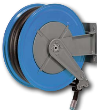
3 Schlauchaufroller für Diesel Hochwertiger Aufroller mit robustem Kunststoffgehäuse. Zwei Rollen garantieren leichtes und einfaches Abrollen des Schlauches. Mit automatischem Stopp System. Für Diesel und Heizöl geeignet. Maximaler Druck 10 bar, Temperatur -20°C bis +50°C. Anschlüsse 1" AG. Mit der passenden Wandkonsole lässt sich der Aufroller noch praktischer einsetzen. Länge Schlauch Best. Nr. EUR (m) 8 3/4" H 65436 398,00 10 1" H 65623 599,00 15 3/4" H 65439 548,00 15 1" H 65651 799,00 Frachtpauschale: 29,00
