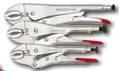
12 Gripzangen-Satz, 3-tlg. Zum Klemmen und Spannen von Profil-, Rund- und Flachmaterial. Längsverzähnte Greifflächen, mit Einstellschraube und Auslösehebel. Einhandbedienung. Oberfläche verchromt. Chrom-Vanadium-Stahl. Inhalt: 7", 10", 12". Best. Nr. H 104853 EUR 57,90
