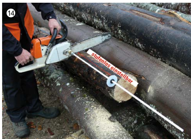
14 VarioMeter - Ablänghilfe Kein mühsames Anreißen! Stufenlos einstellbare Ablänghilfe von 10 bis 105 cm, robuster Fiberglas-Stab mit variablem Endteller, rasch und werkzeuglos kuppelbar, die Druckluftkupplung wird an den Adapterstecker an der Motorsäge gesteckt. Nicht bei Kettenschnellschnitern und verliersicheren Muttern verwendbar. Adapterstück mit M 8 Innengewinde und 19mm Außen-6-kant. Best. Nr. H 28043 EUR 29,95
